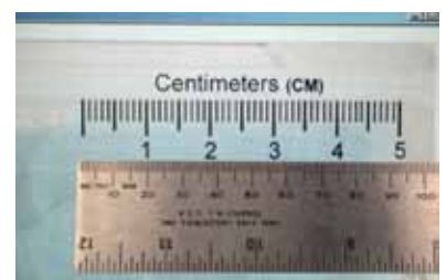
On mesure la latte échelle avec une vraie latte pour calculer le rapport entre les deux
